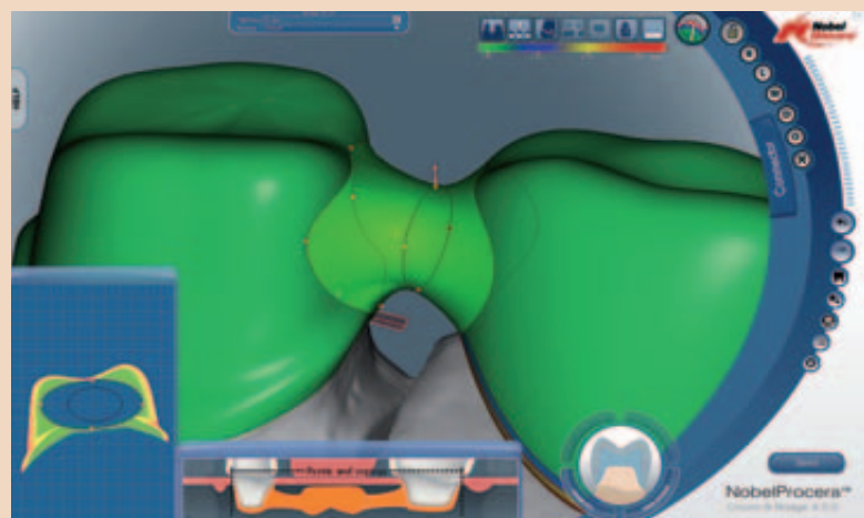
Abb. 3: Ein wesentlicher Aspekt für den langfristigen Erfolg von Brückenkonstruktionen aus Oxidkeramik ist das Design und die Stärke der Verbindungselemente zwischen Brückengliedern und Brückenankern. Neben der Kontrolle der Gesamtquerschnittfläche können die vertikale Höhe und die verbleibende Höhe für die Verblendkeramik leicht kontrolliert werden (NobelProcera™ Software).
