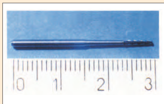
► Fig. 1 : « Fresissima » le corps et la partie active sont tous deux constitués d'un monobloc de carbure de tungstène.
