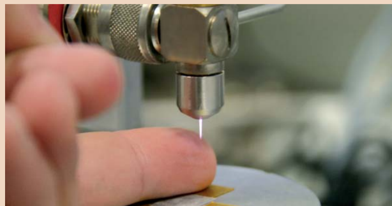
Strumień zimnej plazmy badany w warunkach laboratoryjnych – widok w zbliżeniu (DTI. Zdjęcie dzięki uprzejmości IOM Lipsk).
