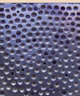
Увеличенное изображение комозитной металлической пены (ДП) (фото любезно предоставлено NCSU, США).
