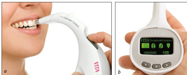
Afb. 5.3a en b De EasyShade Compact (een apparaat voor puntmeting). De tip van het instrument wordt op het tandoppervlak geplaatst. Er kan op één of meerdere plaatsen worden gemeten op natuurlijke gebitselementen, restauraties en kleurtabs. Voor een correct resultaat is het zeer belangrijk dat de tip correct wordt geplaatst.
