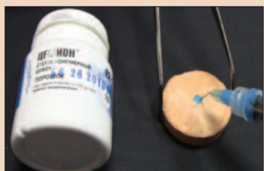
Рис. 4. Нанесение ортофосфорной кислоты на поверхность цемента.
