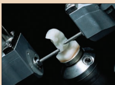
Şekil 4. CEREC 3 cihazına ait freze ünitesi.
