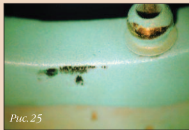
Рис. 20. Снимок областей трения на супраструктуре, сделанный под микроскопом; цветной лак позволяет четко видеть участки абразии металла.
