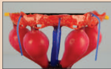
Рис. 16. Снабженная литниками и стабилизирующей балкой супраструктура.
