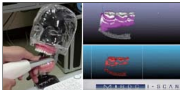
这款手持式蓝色激光口内扫描仪由台湾金属工业研究发展中心开发研制。（图片来源：Youtube/solberg hu）
