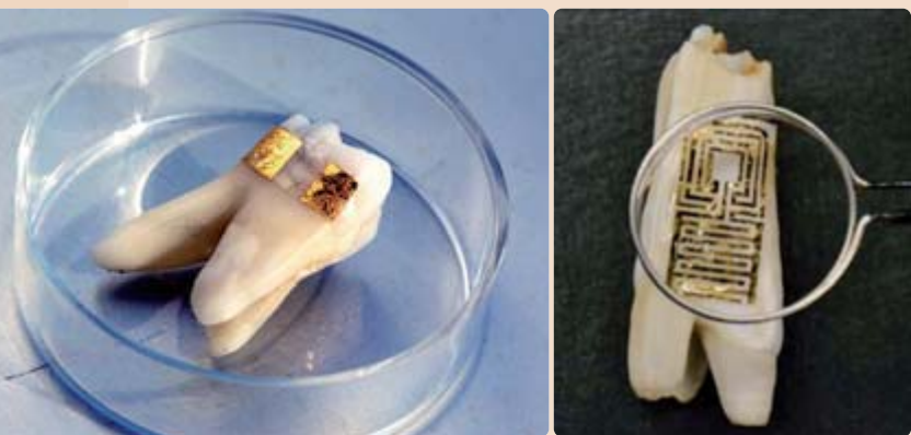
Graphen-basierter Nanosensor auf Zahnschmelz. (Fotos: McAlpine Research Group)
