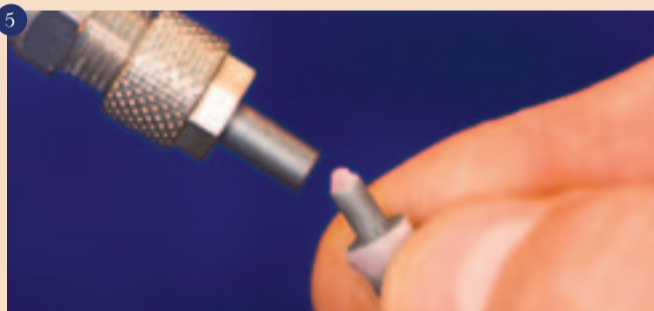
Spesčajte vezavno površino Ti nadgradnje z 50 µm Al 2 O 3 in maksimalno 2 bari.
