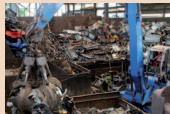
Der Greifarm packt die Geräte in den Schredder.
