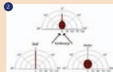
2 Lastnosti razpršitve svetlobe pri univerzalnih masah Beautifil II v primerjavi z dentinom in emajlom.
