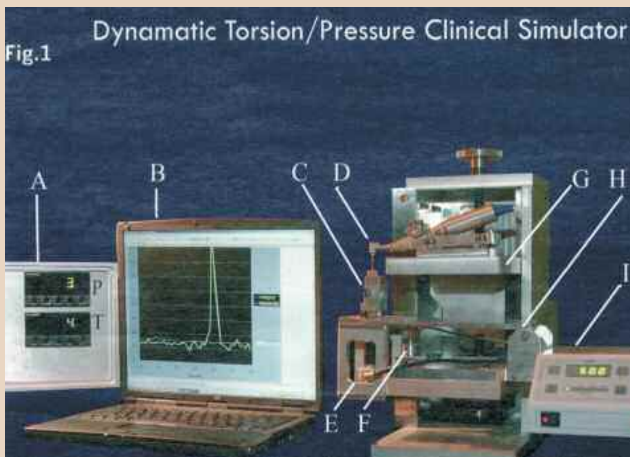
Εικ. 2. Η επιθυμητή περιστροφική ταχύτητα της ρίνης ρυθμίζεται από το κιβώτιο ελέγχου της χειρολαβής (I). Η χειρολαβή τοποθετείται σε μία βάση (G) που χρησιμοποιείται για ακριβή αναπαραγωγή επιλεγμένων κινήσεων εισόδου-εξόδου. Ο ριζικός σωλήνας τοποθετείται σε ένα άγκιστρο (C). Το άγκιστρο στηρίζεται από μία αναρτώμενη βάση (H). Η παραμόρφωση που ασκείται από τη ρίνη μετράται με ένα μετρητή περιστροφικής δύναμης (E) κι η πίεση μετράται από ένα μετρητή πίεσης (F). Η πίεση κι η περιστροφική δύναμη παρακολουθούνται ταυτόχρονα σε μία οθόνη (A). Οι προκύπτουσες μετρήσεις σε πραγματικό χρόνο στηρίζονται σε γραφικά προγράμματα (B).
