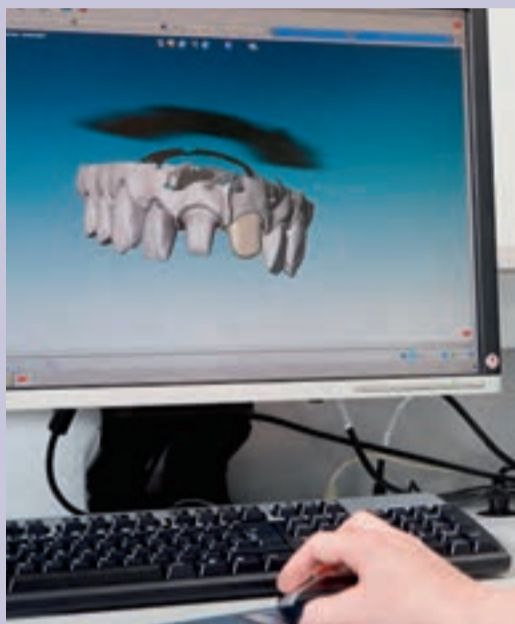
Ontwerpen van twee onderstructuren voor opgebakken zirkoniumoxide-kronen.
