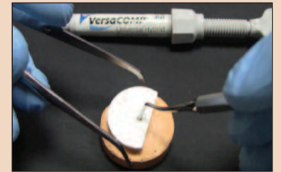
Рис. 7. Установка композитного столбика на поверхность цемента.
