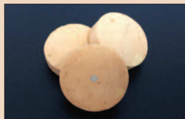
Рис. 1. Исследуемые образцы – гипсовые цилиндры с СИЦ.
