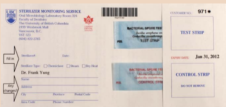
Ryc. 2: Przykładowe wskaźniki, które poddawane są testom wykazującym poziom skuteczności sterylizacji narzędzi w gabinecie.
