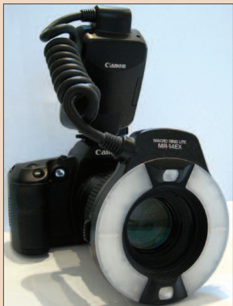
Рис. 1. Цифровой однообъективный фотоаппарат Canon EOS 40D с объективом 105 мм, круговой и двойной вспышками.
