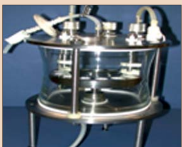
사진 2. 치아 표면에서 자연적으로 발생하는 것과 유사한 구강 균막의 성장을 위해 constant depth film fermenter (CDFE)가 사용되었다.
