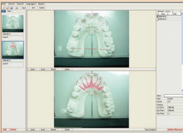
Resim 4. CAPRO (IV-Tech, Kore) El yapımı ClearAligner'lerin yapımı için kullanılan 2B mevcut durum fotoğrafının üst üste görülmesini sağlayan yazılım programı.
