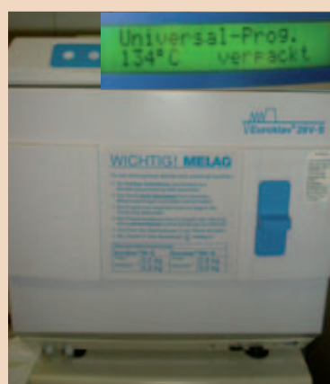
MELAG Euroklav 29 V-S – Sterilisationstemperatur 134 °C.
