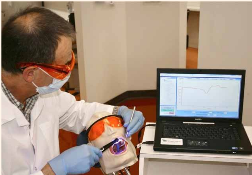
El sistema de prueba de fotocurado MARC
