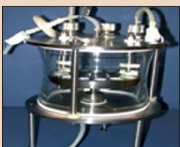
사진 2. 치아 표면에서 자연적으로 발생하는 것과 유사한 구강 균막의 성장을 위해 constant depth film fermenter (CDF)가 사용되었다.
