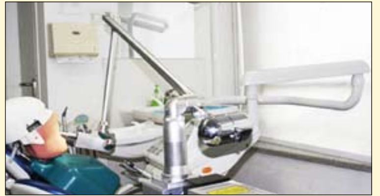
在最近的一项研究中，对一项运用机器人利用超短波脉冲激光以及三维动作控制技术来进行牙体预备的新技术进行了首次试验。
