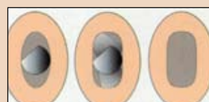
Εικ. 4 Εικόνα ενός ασύμμετρα σχεδιασμένου εργαλείου και της δυνατότητάς του να διαχωρίζεται και να καθαρίζει ένα σωλήνα με ωσειδή διάμετρο.
