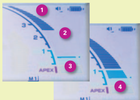
(1) Großes Farb-Display, (2) Farbige Balkenanzeige, (3) Variable Arbeitslängen-Anzeige, (4) Grüner Indikator zur Darstellung des Apex
