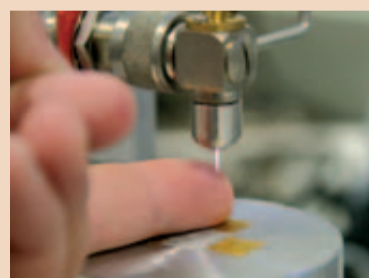
Im Bild die am IOM Leipzig entwickelte miniaturisierte Plasmaquelle mit gezündetem Plasmajet.
