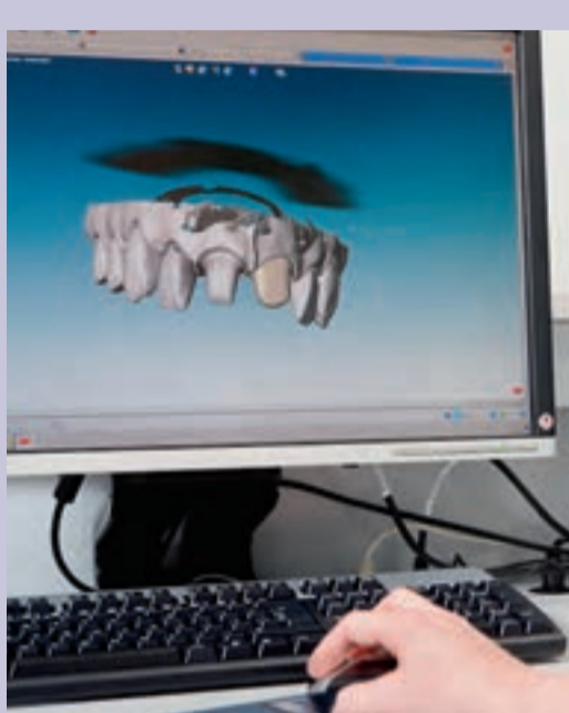
Ontwerpen van twee onderstructuren voor opgebakken zirkoniumoxide-kronen.
