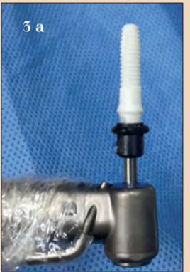
Resim 3a'dan 3c'ye kadar: Tek parça ZiBone zirkonya implant (4 mm çap, 12 mm uzunluk).
