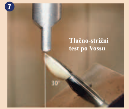
7 Shematski prikaz tlačno-strižnega testa po Vossu.
