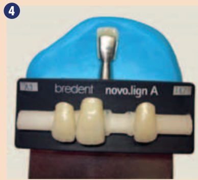
4 Za lepljenje pripravljene, novo.lign luske na nosilcu za testiranje. (Lepljenje po Bredentovem protokolu z combo.lign.)
