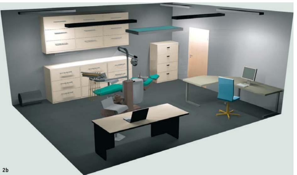
Fig. 2a : Visualisation 3D de la situation présentée à la Fig. 1a. L'éclairage est conçu sur la base des exigences relatives à un environnement de travail en bureau. L'installation ne respecte pas les zones de tâche supplémentaires. | Fig. 2b : Visualisation 3D de la situation présentée à la Fig. 1b. Un aperçu d'une salle modèle équipée d'une dalle lumineuse directionnelle / non directionnelle et d'autres luminaires supplémentaires afin de tenir compte des zones de tâche supplémentaires.
