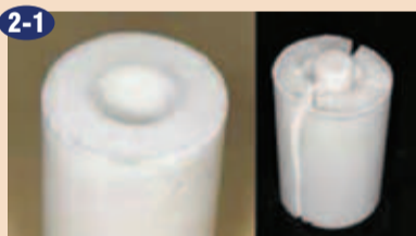
Levo: razpoke po pečenju. Ko kiveto damo v peč na temperaturo 500°C in nato dvignemo temperaturo na 900°C, lahko kiveta počni kot je prikazano na sliki.
