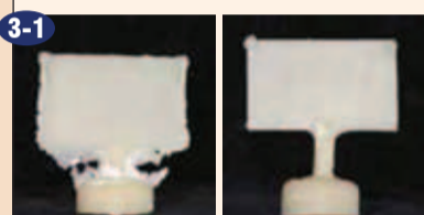
Dolžina dolivnega kanala na levi in na desni fotografiji je 3 mm oziroma 5 mm. Vosek Ready Casting Wax R25 je bil uporabljen za oba dolivna kanala in 0,46 mm debeli listi voska za stiskanje.
