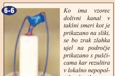
6-6 Ko ima vzorec dolivni kanal v takšni smeri kot je prikazano na sliki, se bo zrak zlahka ujel na področje prikazano s puščicama kar rezultira v lokalno nepopolnih robovih.
