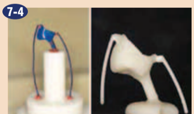
7-4 Dolžina odvoda pod primernimi pogoji tlačjenja. Odvod ob prešanju postaja krajši, če je keramika nezadovoljivo mehka, in nasprotno daljši, ko je premehkka. Parametri peči se morajo prilagoditi glede na pogoje prešanih odvodov.
