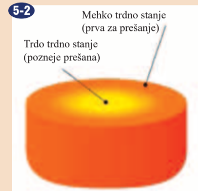
Stanje talilnega ingota v preseku.
