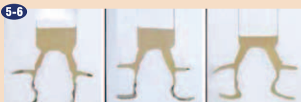
5-6 Prešanje v kalup v vložni masi.
