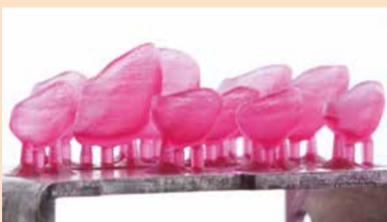
Slika 5: Isprintane ljske od sintetičke smole.
