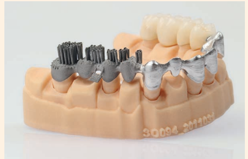
Additív gyártás – a lézerszinterelés lépcsői.
