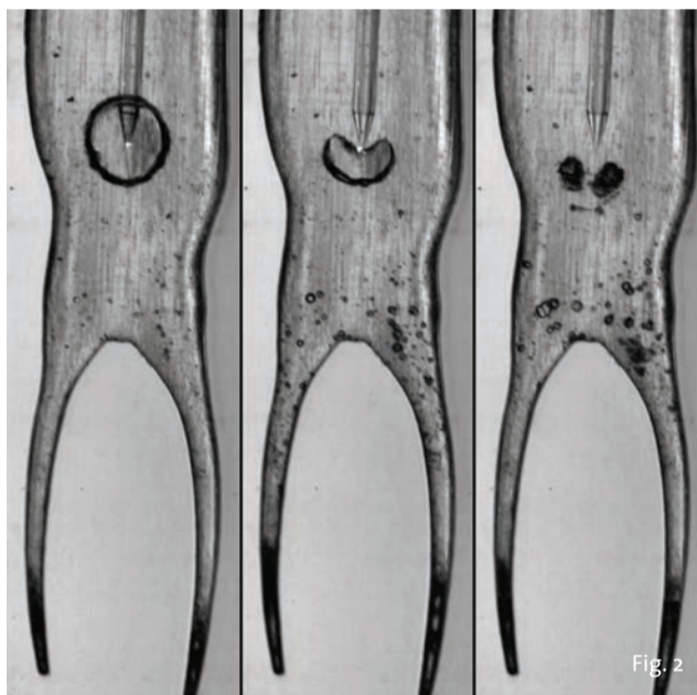
Fig. 2 - Rappresentazione sperimentale del fenomeno primario di esplosione-implosione, utilizzando laser Er:YAG LightWalker AT, Fotona e punta SWEEPS-Radial 400 micron. A sinistra esplosione dell'acqua intorno alla punta laser a pochi microsecondi dall'impulso generato. Al centro implosione della bolla; notare le bollicine di cavitazione già presenti nello spazio canalare. A destra, formazione di bolle di cavitazione secondaria dopo l'implosione della bolla.
