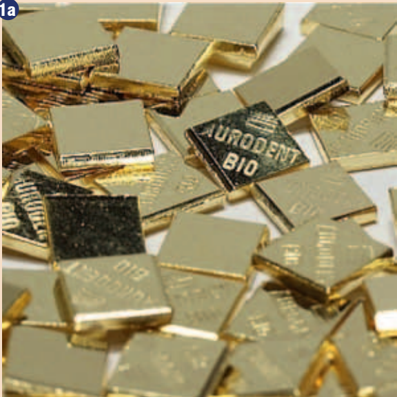
Sliki 1a in 1b: Primer plemenitih dentalnih zlitin (a) na osnovi Au (Aurodent BIO) in (b) na osnovi Ag (Auropal S).
