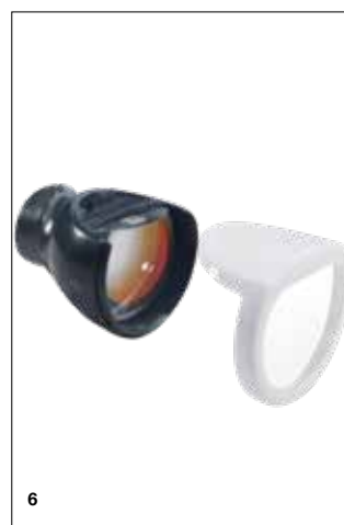
Slika 6: Varioclipi se pritisnejo na okularje in določijo delovno razdaljo s šestimi izbirnimi prednastavitvami od 25 do 50 cm v korakih po 5 cm. Lahko jih kadar koli zamenjate in zagotavljajo zaščito pred praskami na okularju. Zato se morebitna obraba pojavi le na zamenljivih Varioclipih in ne na dražjih okularjih.
