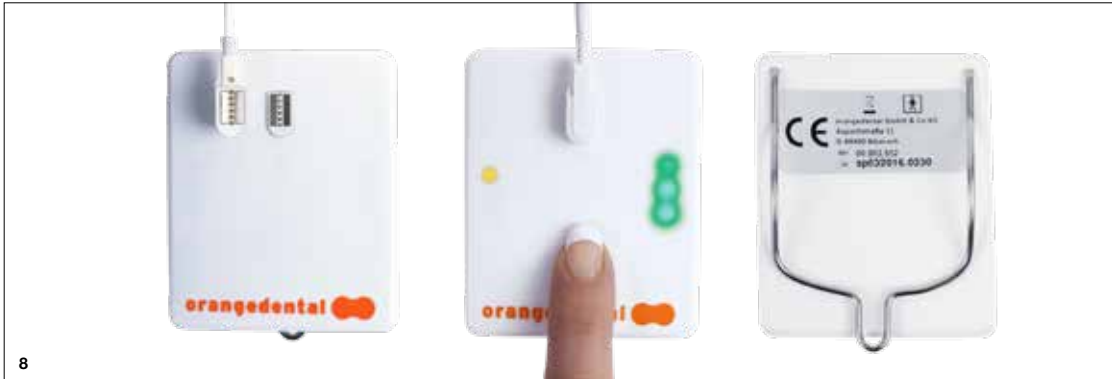
Slika 8: "One-Touch" za spreminjanje in prikaz jakosti svetlobe v treh stopnjah za baterijo s kablom, ki se nosi na oblačilih ali pritrjena na roko.
