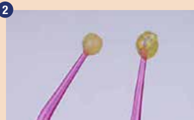
G2-BOND Universal: 1-PRIMER in 2-BOND. Njena rumenkasta barva pomeni prisotnost fotoiniciatorja v obeh komponentah. Barva po polimerizacijski reakciji izgine.
