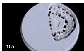
Slika 10a, 10b in 10c: Večja restavracija iz cirkona. Slika 10a: Rezkana struktura v zeleni fazi. Slika 10b: Mikroslojeno ogrodje s prenosniki Ti. Slika 10c: Po namestitvi v ustih.
