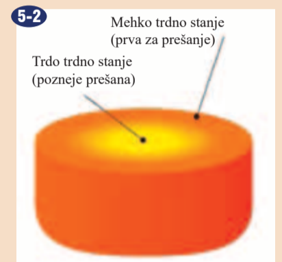
Stanje talilnega ingota v preseku.
