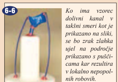
6-6 Ko ima vzorec dolivni kanal v takšni smeri kot je prikazano na sliki, se bo zrak zlahka ujel na področje prikazano s puščicama kar rezultira v lokalno nepopolnih robovih.
