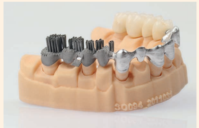
Additív gyártás – a lézerszinterelés lépcsői.
