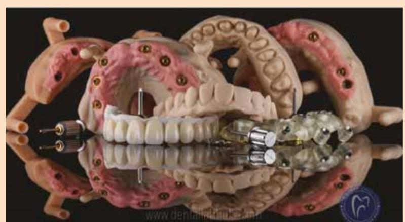
Slika 2: 3D štampani modeli, hiruški stentovi, prototipovi mosta itd.
