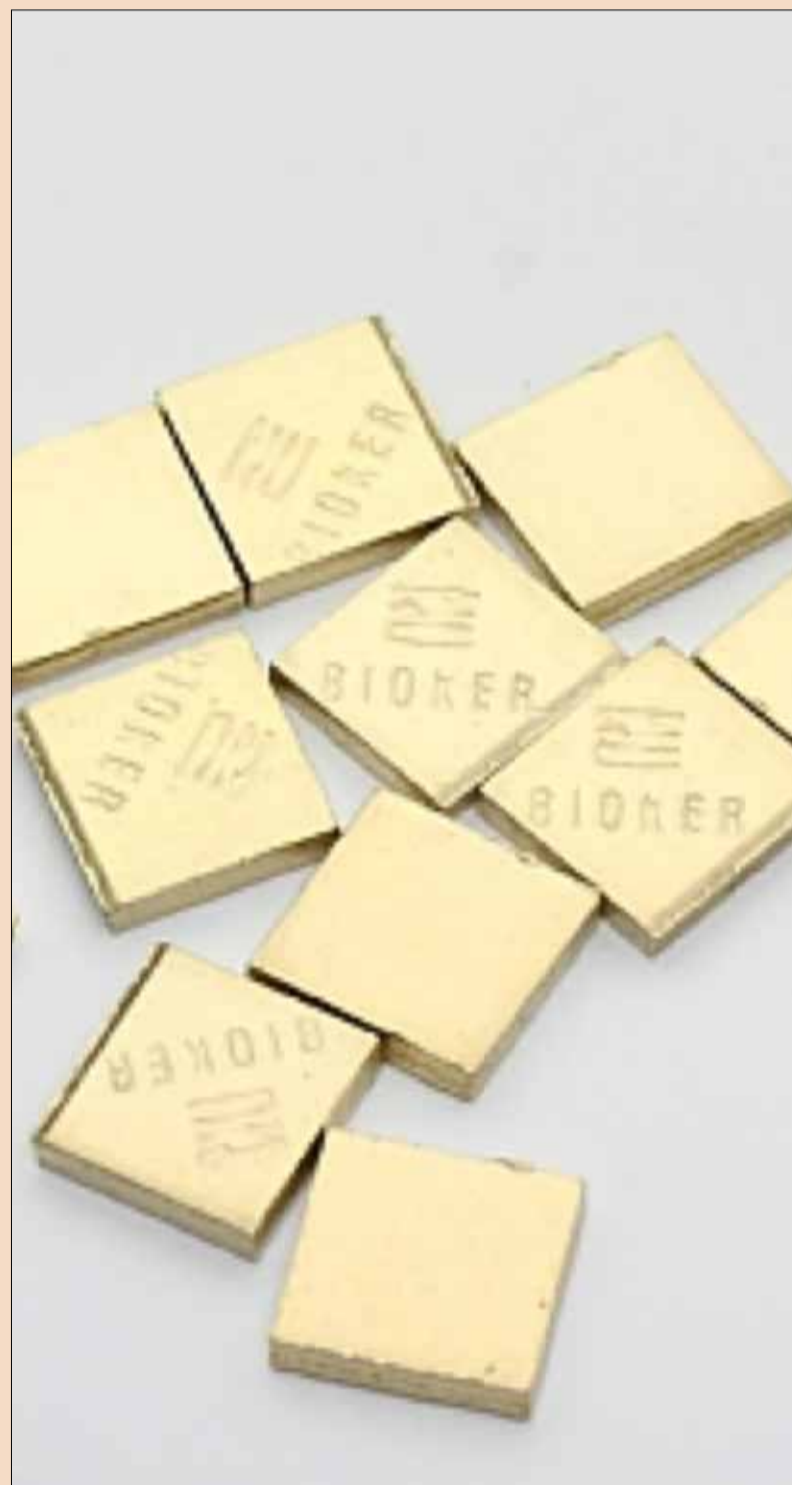
Visoko-zlata dentalna zlitina BIOKER za porcelansko tehniko s kemijsko sestavo (v masnih %): Au 85,90%; Pt 11,70%; Zn 1,50%; ostalo (Rh, Ir, Nb, Mn, In, Fe) <1%
