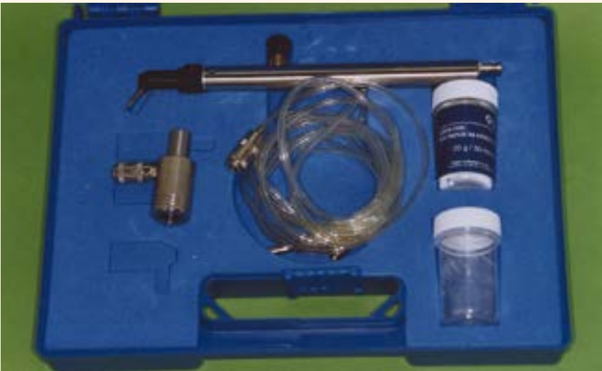
Figura 1. Imágen de los componentes como la manguera de conexión, voladura contenedor de polvo, así como acoplamientos y adaptadores opcionales que se incluyen en la entrega.
