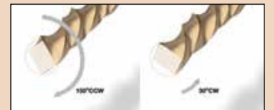
Εικ. 4 Η ρίνη περιστρέφεται κατά 150 μοίρες αντίθετα με τη φορά των δεικτών του ρολογιού και 30 μοίρες κατά τη φορά των δεικτών του ρολογιού, πραγματοποιώντας περιστροφή 360 μοιρών μετά από τρεις κύκλους παλινδρομικής κίνησης.
