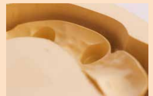
Sl. 3d: Površina BioHPP sa dobro izabranom strategijom koja ostavlja odličnu površinu
