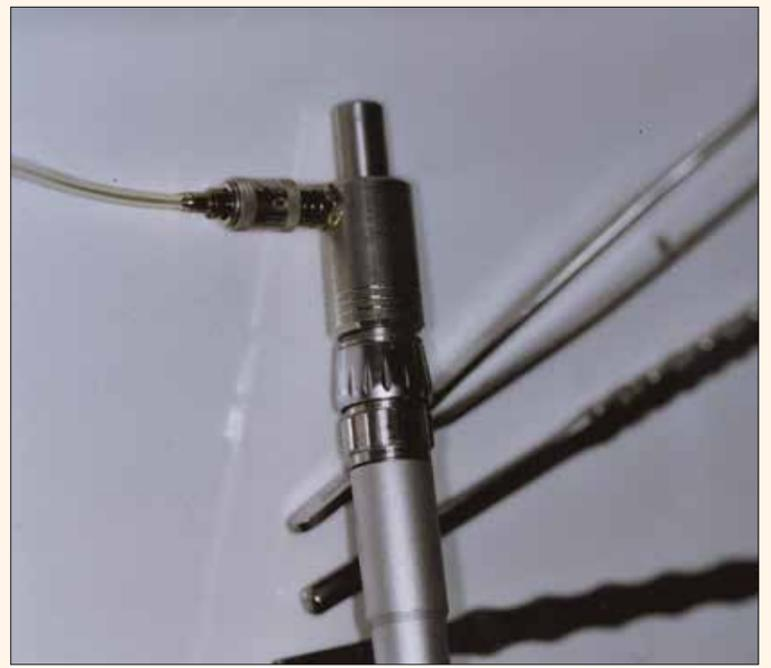
Fig. 2 : Il existe un adaptateur pour le raccordement à chaque turbine (et pour le raccordement au compresseur d'air des laboratoires dentaires).
