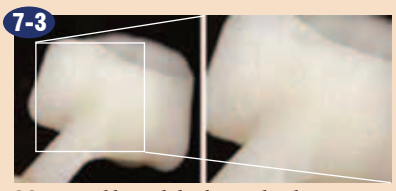
7-3 Mnogo naključnih lunkerjev kot krater.
