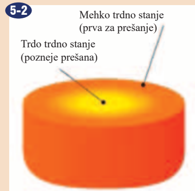
Stanje talilnega ingota v preseku.
