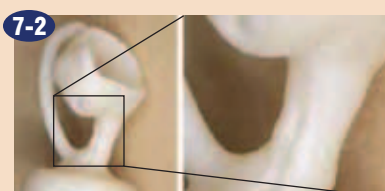
Sledi zraka, ki je ušel preko dolivnega kanala.
