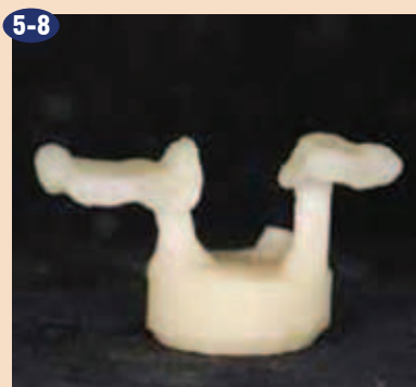
Če so dolivni kanali v takšni smeri, kot je na sliki, se pritisk ne more popolnoma izvajati do najglobljih delov izdelka, kar ima za posledico neuspeh.
