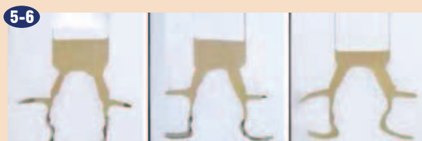
Prešanje v kalup v vložni masi.
