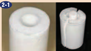
Levo: razpoke po pečenju. Ko kivet damo v peč na temperaturo 500°C in nato dvignemo temperaturo na 900°C, lahko kivet poči kot je prikazano na sliki.
