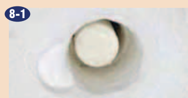
Kot je prikazano na sliki, se prešana keramika pospešeno akumulira na površini bata, če je ne odstranjujemo redno. Zaradi tega je potrebno redno čiščenje in odstranjevanje keramike z bata za pritisk.
